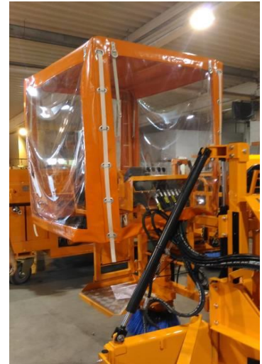
Osłona przeciwdeszczowa stanowiska operatora
