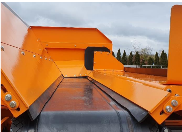
Dostępna taśma podająca o wyższej wytrzymałości na temperaturę oraz standardowa do materiałów sypkich
